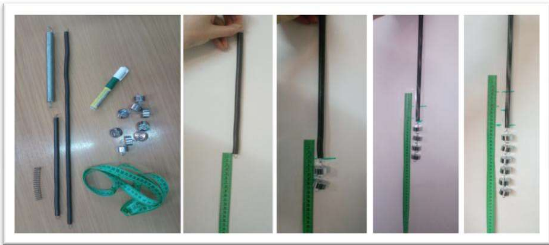
Σχήμα 6: Υλικά και διαδικασία δημιουργίας κλίμακας δυναμόμετρου
